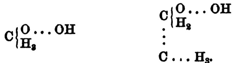
Man sieht leicht, dafs in dem Methylalkohol die Verbindungsgrenze für den Kohlenstoff = 4 ist, da der Kohlenstoff darin mit 3 At. Wasserstoff und 1 At. Sauerstoff verbunden ist; dieses Sauerstoffatom, dessen Verbindungsvermögen = 2 ist, ist wiederum mit einem anderen Sauerstoffatom vereinigt, welches seinerseits mit 1 At. Wasserstoff verbunden ist.
