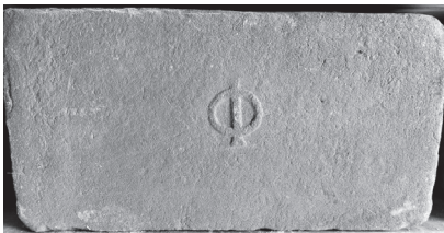
Лл. 7. Опукле клеймо на цеглі виробництва ймовірно Фінченка
