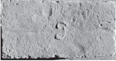
Лл. 9. Опукле клеймо на цеглі виробництва С. Ф. Роєва
