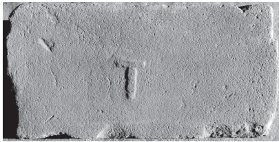
Ил. 17. Спрощене опукле клеймо на цеглі виробництва Х. Х. Тільмана
