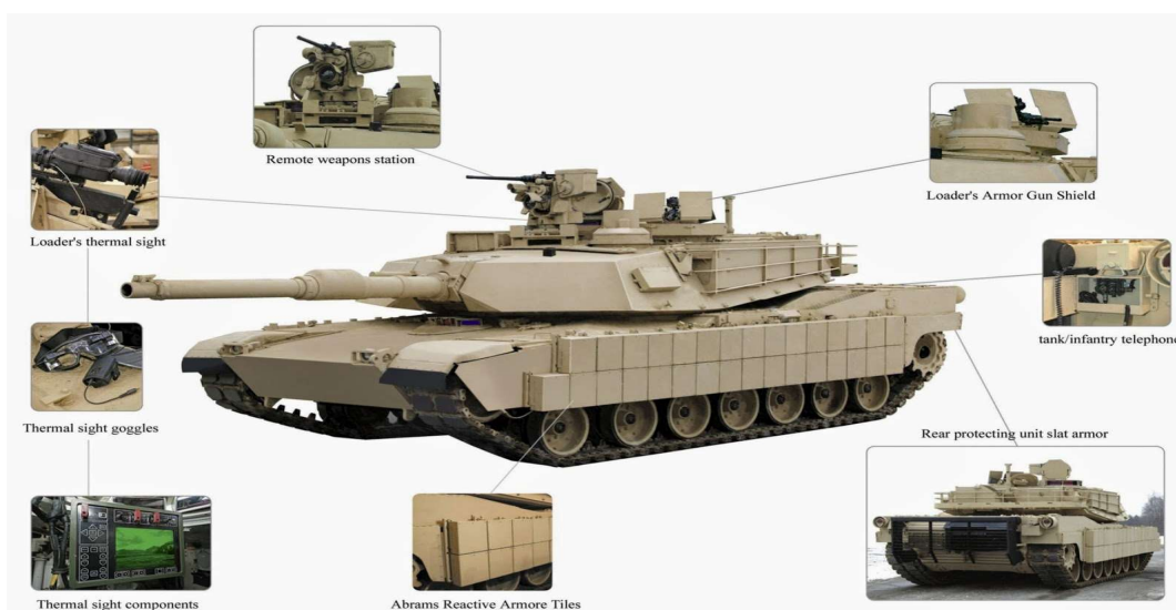
FIGURA 3 – Principais sistemas que compõe o Tank Urban Survival Kit (TUSK)
