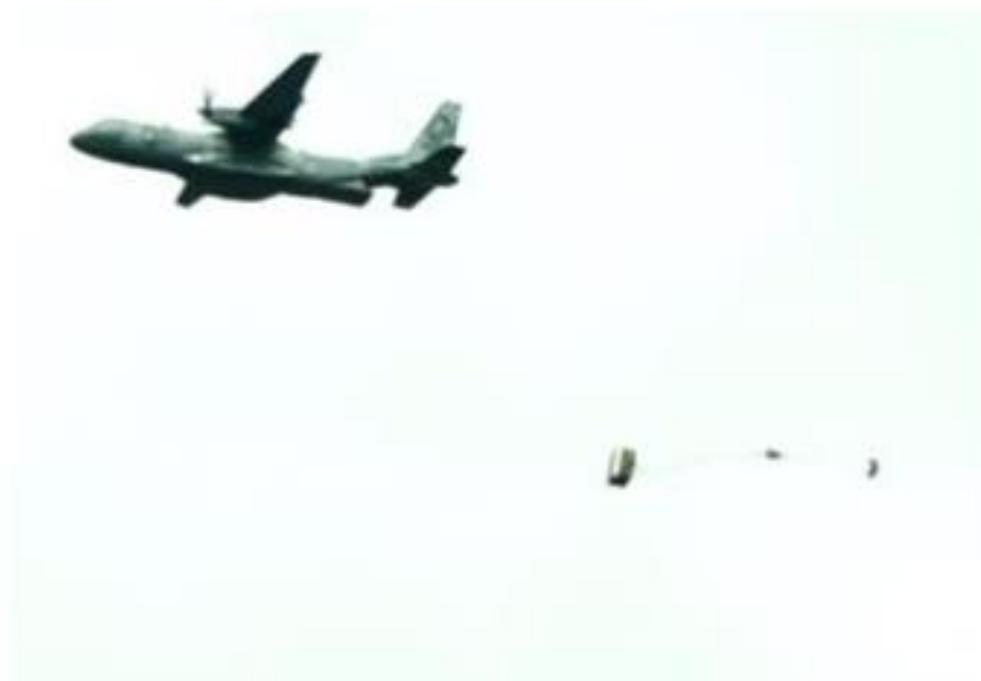
Figura 19: Lançamento do hidropallet para ressuprimento do Curso de Operações na Selva
