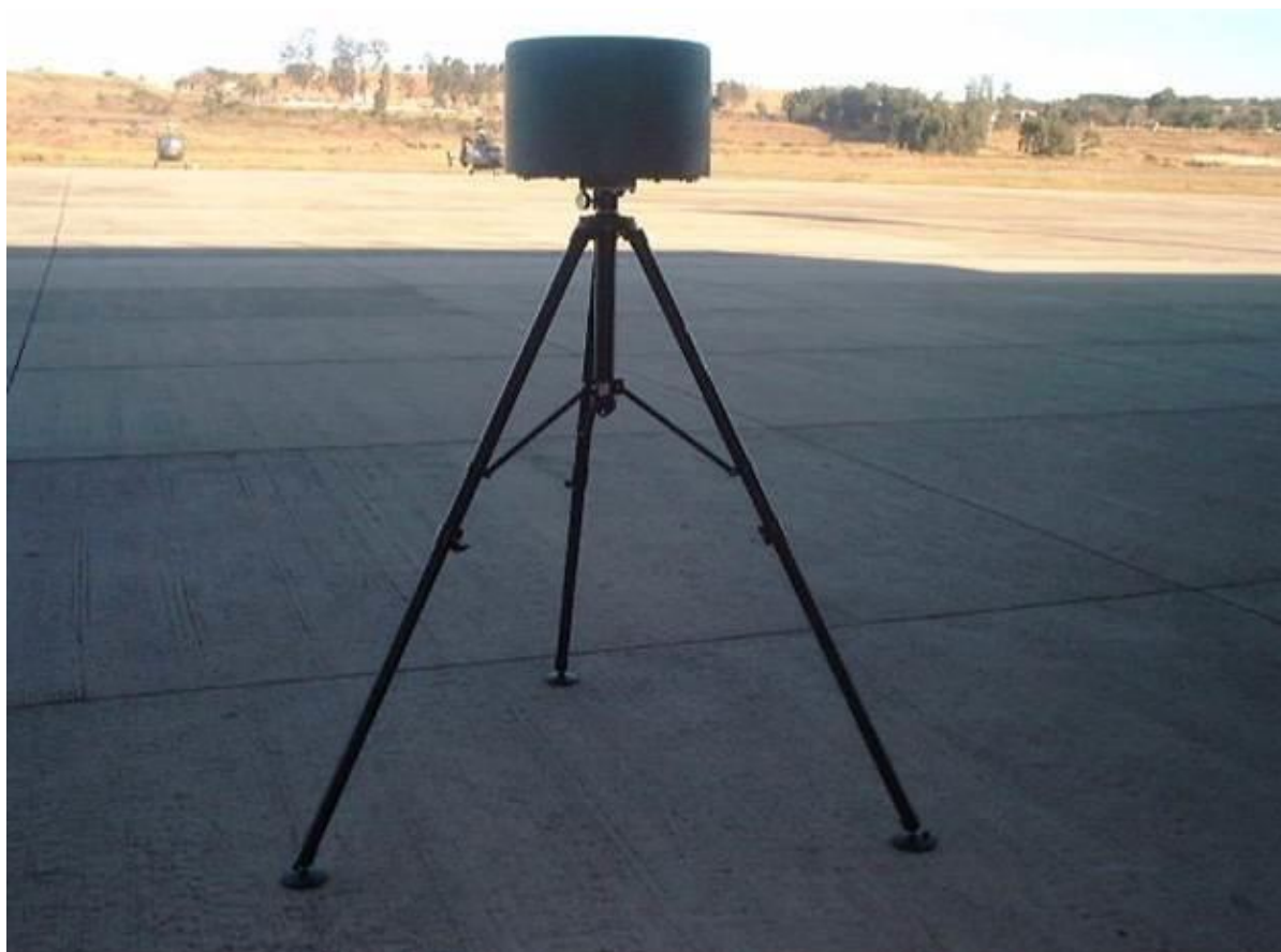
Figura 14 – Antena receptora/ Estação de Terra (Sistema Olho da Águia)
