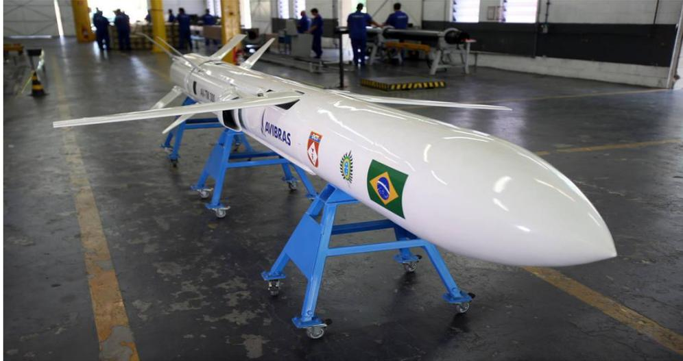
Figura 12 – AV-TM 300, na configuração com duas asas
