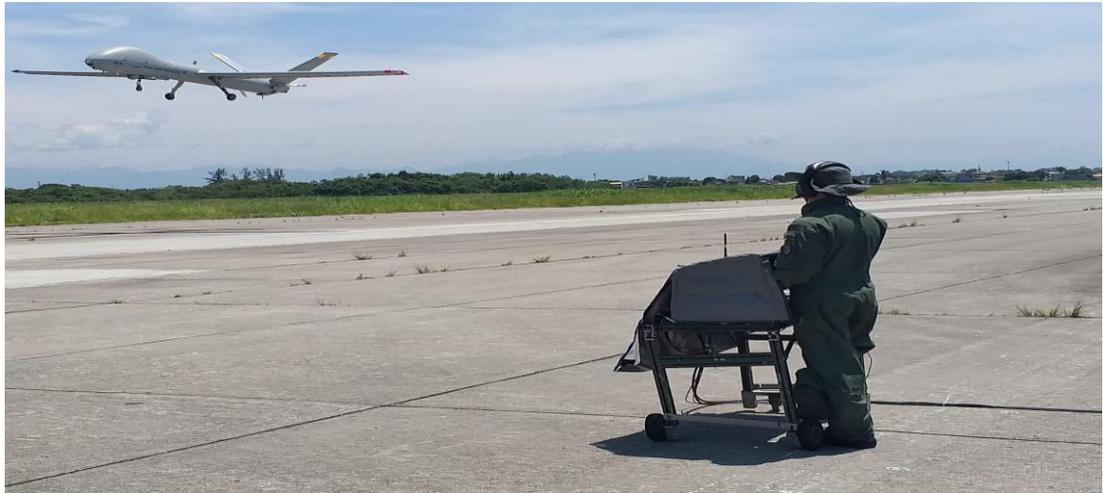
Figura 13 – ARP modelo RQ-900 controlado via satélite
