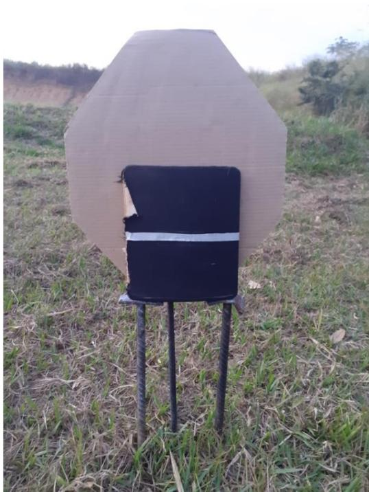
O primeiro teste foi realizado utilizando-se o fuzil IA2 calibre 5,56mm e efetuando dois disparos na região inferior da placa balística. Como resultados, tiveram penetrações médias na proteção, perfurando menos da metade de suas camadas. A deformação da retaguarda da placa foi baixa, gerando apenas um pequeno estufamento, tanto da região do primeiro quanto do segundo impacto.
