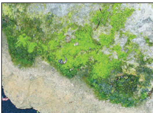
Fig. 5 - Eșantion de piatră contaminat cu mușchi
