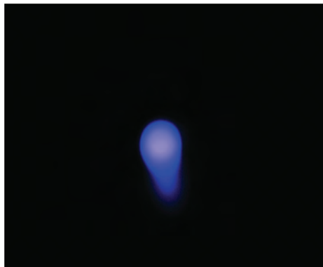
Fig. 2 - Descărcare Corona de HF, v = 1,3 MHz*
