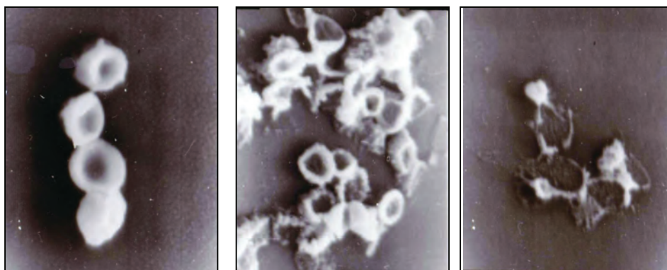
Fig. 8 Imagini electrono-microscopice a sporilor de fungi depuși pe suport de sticlă înainte și după tratamentul în plasmă: a - proba martor; b - probă tratată 30 min.; c - probă tratată o oră.
