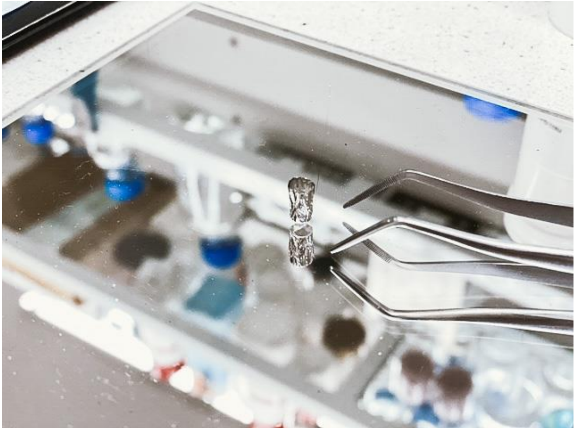
Fot. 5 Kapsułka cynowa, wykorzystywana do pomiarów spektrometrycznych. Zdjęcie z archiwum autorki.
