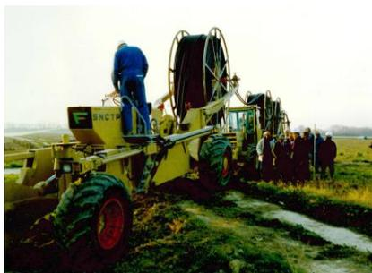
1991 Entwicklung des Seilwindenzugfahrzeuges FWF 50 mit 50 Tonnen Zugleistung bei Einfachzug
