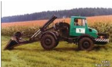
1980 Entwicklung des Seilwindenzugfahrzeuges FWF 30 zur Serienreife mit 30 Tonnen Zugleistung bei Einfachzug auf Unimog 150 PS
