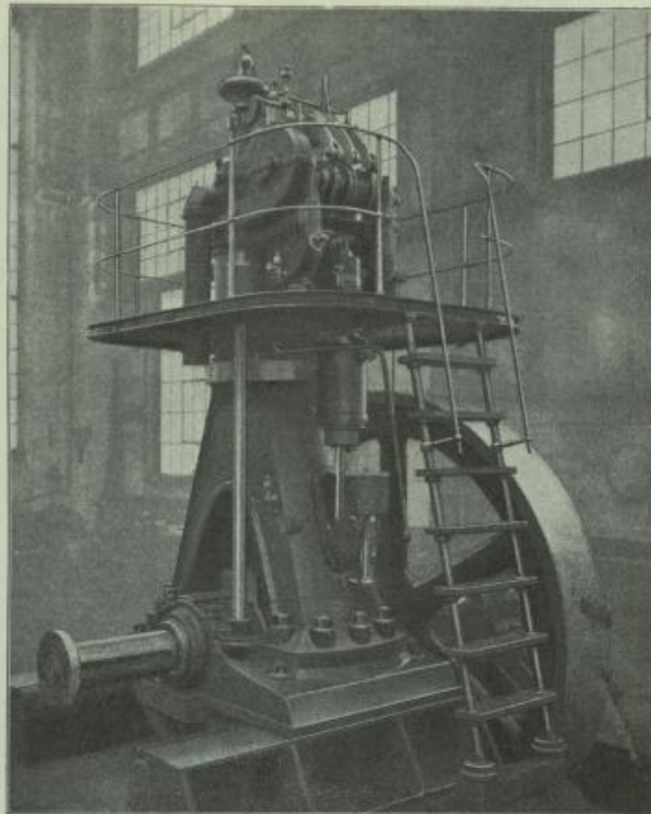
Einzyylinder-Dieselmotor von 100 eff. Pferdestärken zum Antrieb einer Dynamo. Ausgeführt für das »Victoriahaus« in Breslau.
