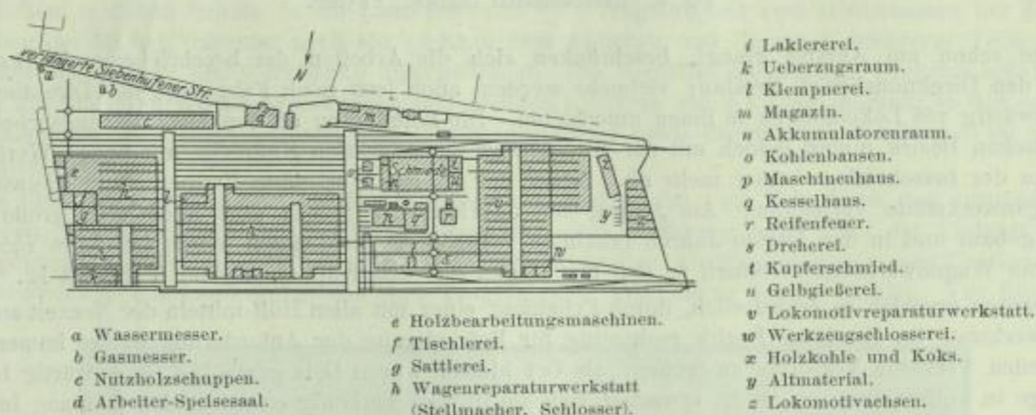
Fig. 5. Lageplan der Hauptwerkstatt Breslau-Freiburg. Zustand vom 1. Januar 1905. 1:5000.
