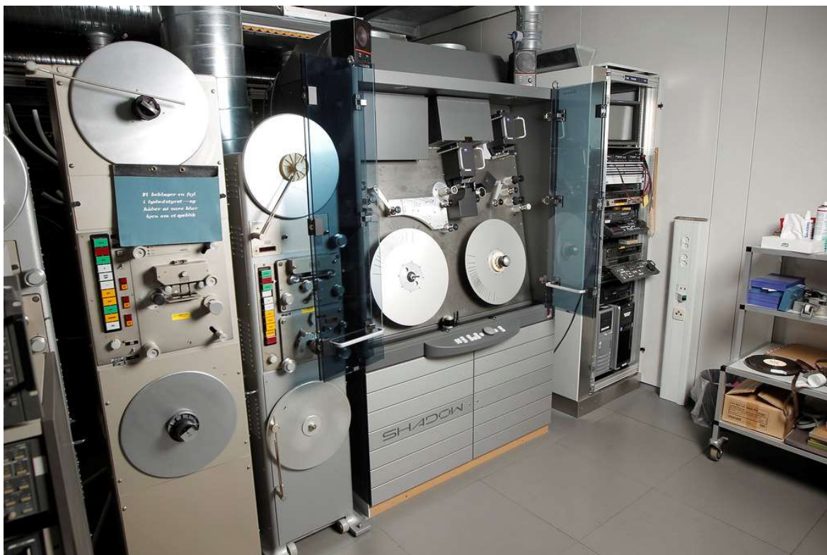
Figura 9: Spirit Datacine SDC2000 de 2K de resolución. (Fuente: Cinecolor, 2023)
