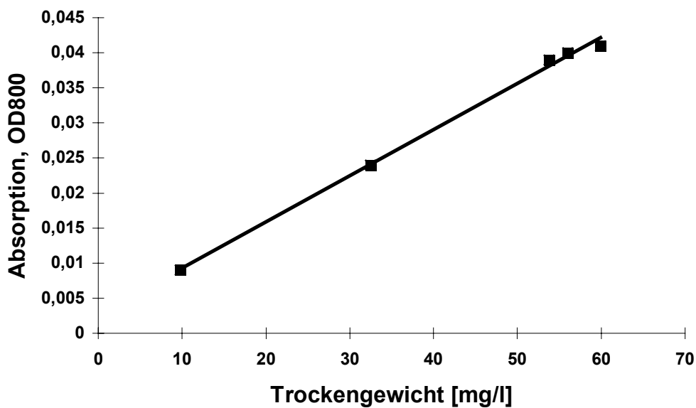
Abb. 27: Korrelation zwischen der Messung der Absorption bei 800 nm und der Bestimmung des Trockengewichts für den Klon AB97.017A2.
