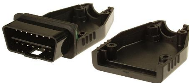
Obr. 24: Rozebíratelný OBDII konektor – přední strana (převzato z [15]).
