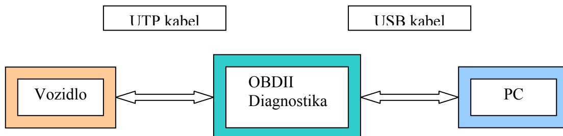
Obr. 12: Blokové schéma hardwarové realizace diagnostiky.
