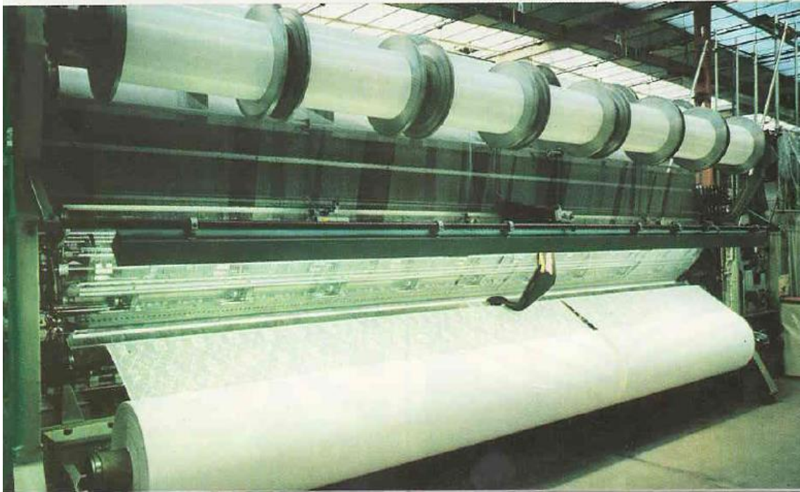
Příloha č. 10: Rašlový pletací stroj na výrobu jemných pletených záclon, pracovní šíře je 5 metrů
