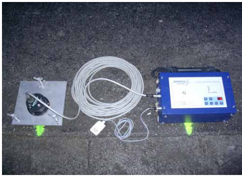
Obr. 6) BRIMOS Recorder s dodatečnými senzory (vlevo) a jeho umístění na menších mostech (vpravo)
