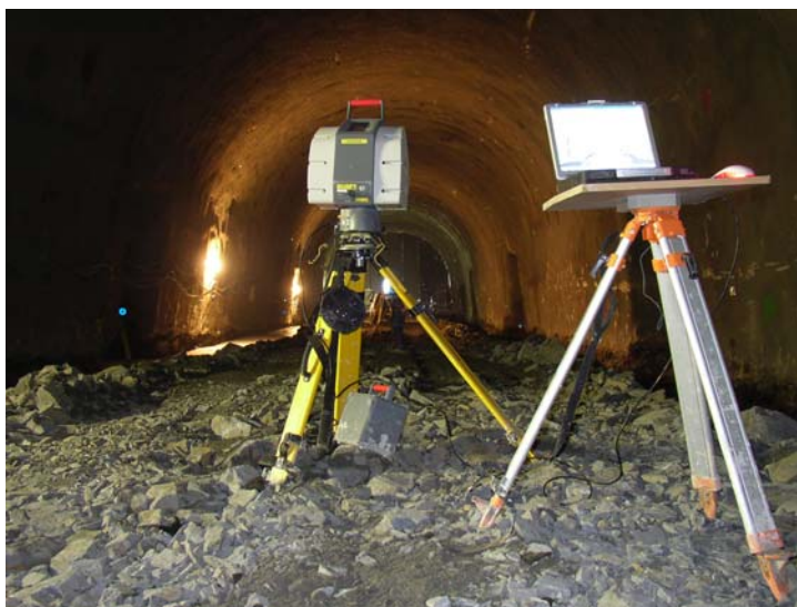
Obr. 1 - Laserový skenovací systém HDS 3000
