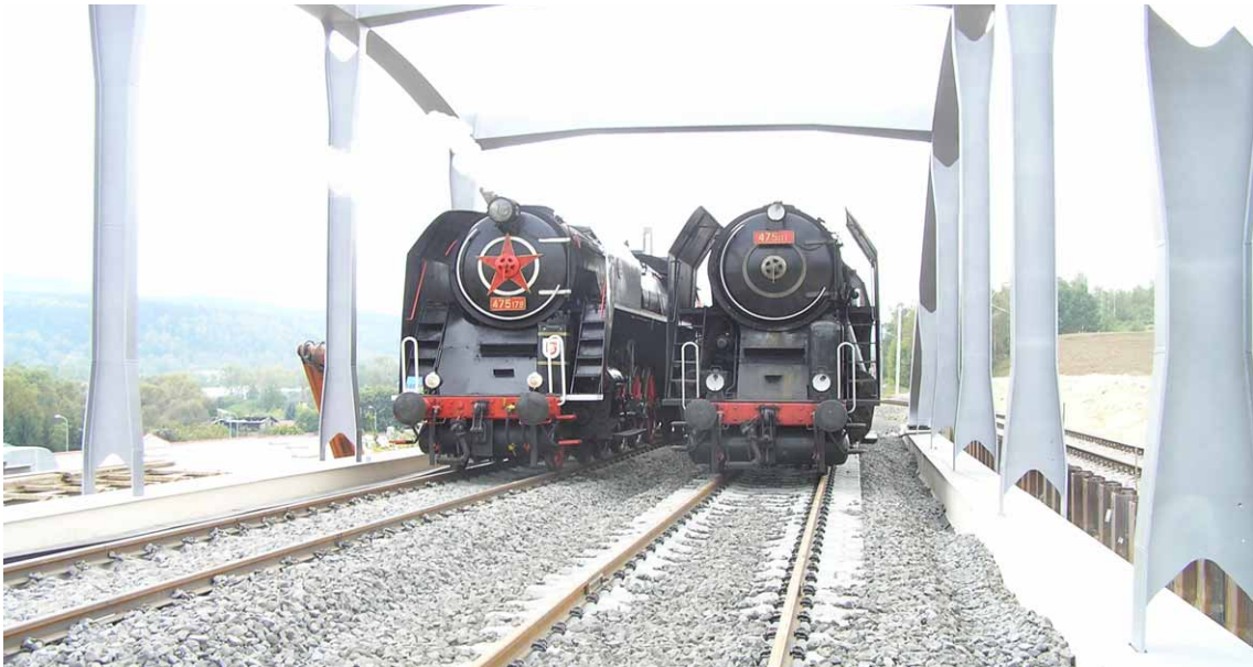
Obr. 5 Poloha zkušebního zatížení pro dotlačení opěr
