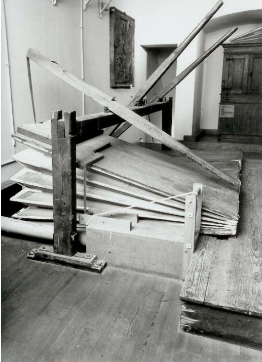
Abbildung 187 Linker Balg als Magazinbalg, im Vordergrund das Drosselventil
