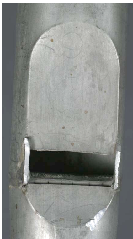
Abbildung 72 entfernter Seitenbart bei D
