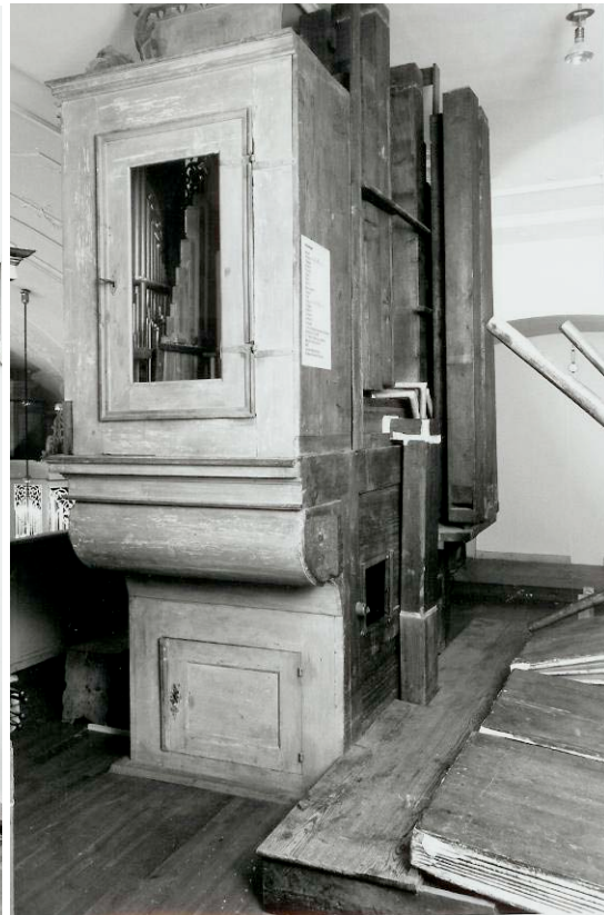
Abbildung 186 Liegender Sammelkanal und senkrechter Zubringer zur Windlade
