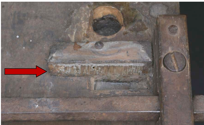
Abbildung 120 Spur vom ehemaligen Raster des Quintbas: Abrissspur am Klötzchen, davor die Nut für einen Zapfen.
