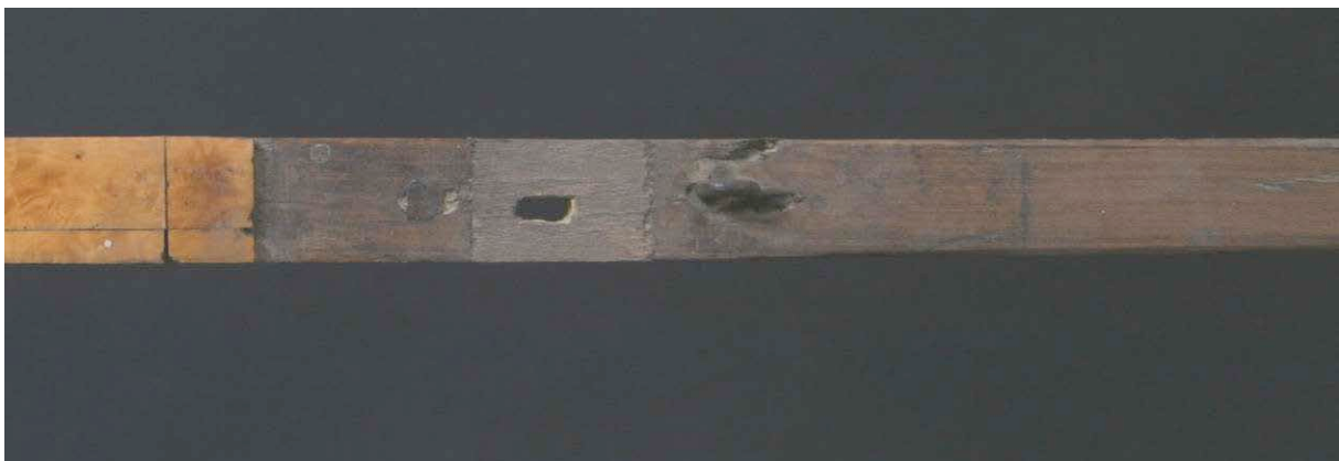
Abbildung 157 Ahorn-Einlage bei der Vorderstiftführung, links davon das zugeübelt ehemalige Ösenloch bei d°.
