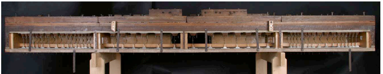
Abbildung 84 Vorderansicht Manuallade mit Stöcken
