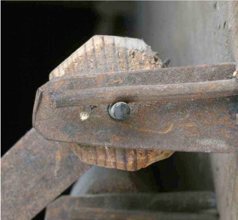
Abbildung 125 Döckchen in Seitenansicht, Ecken abgefeilt; auf die Achse übt ein Metallstift Druck aus, um Geräusentwicklung zu verhindern.
