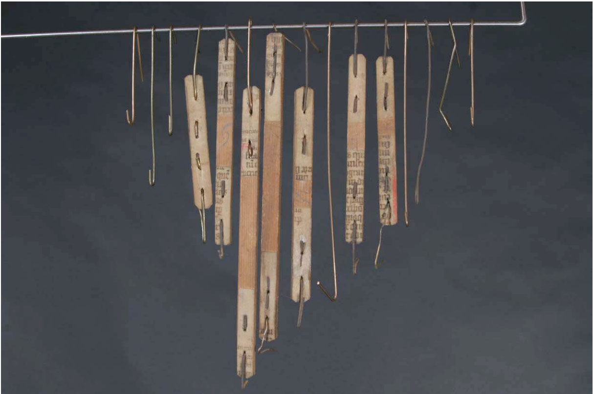
Abbildung 131 Die oberen Abstrakten des Pedalwellenbretts, teilweise in Draht ausgeführt.
