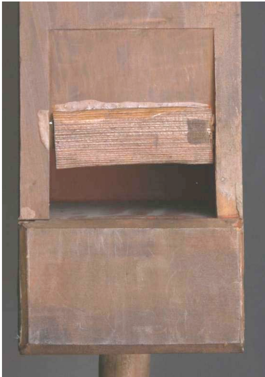
Abbildung 58 Ausgedünnte rechte Seitenwand, erkennbar an der abgehobelten rechten Vorschlag-Fase bei fs^\circ
