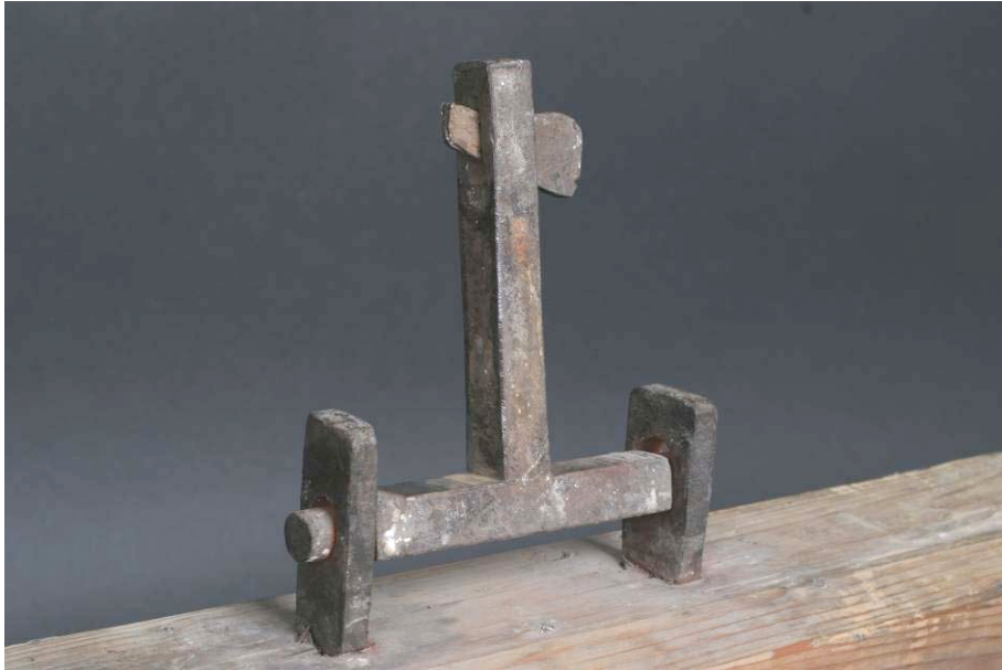
Abbildung 201 Achslager für das Scharnier
