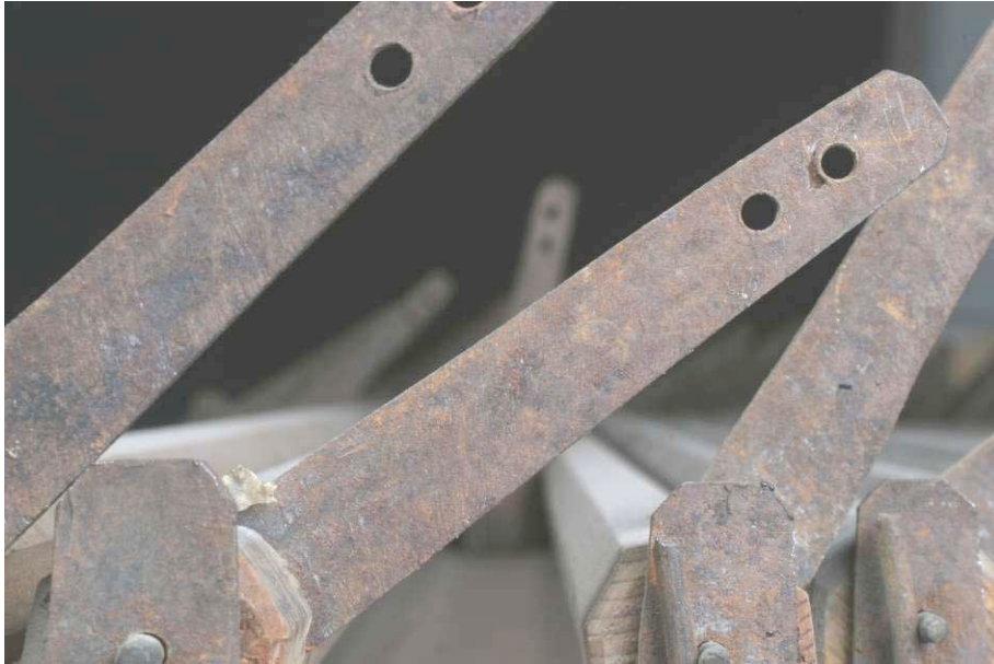
Abbildung 127 Abzugsärmchen mit zwei Bohrungen für die Abstrakten
