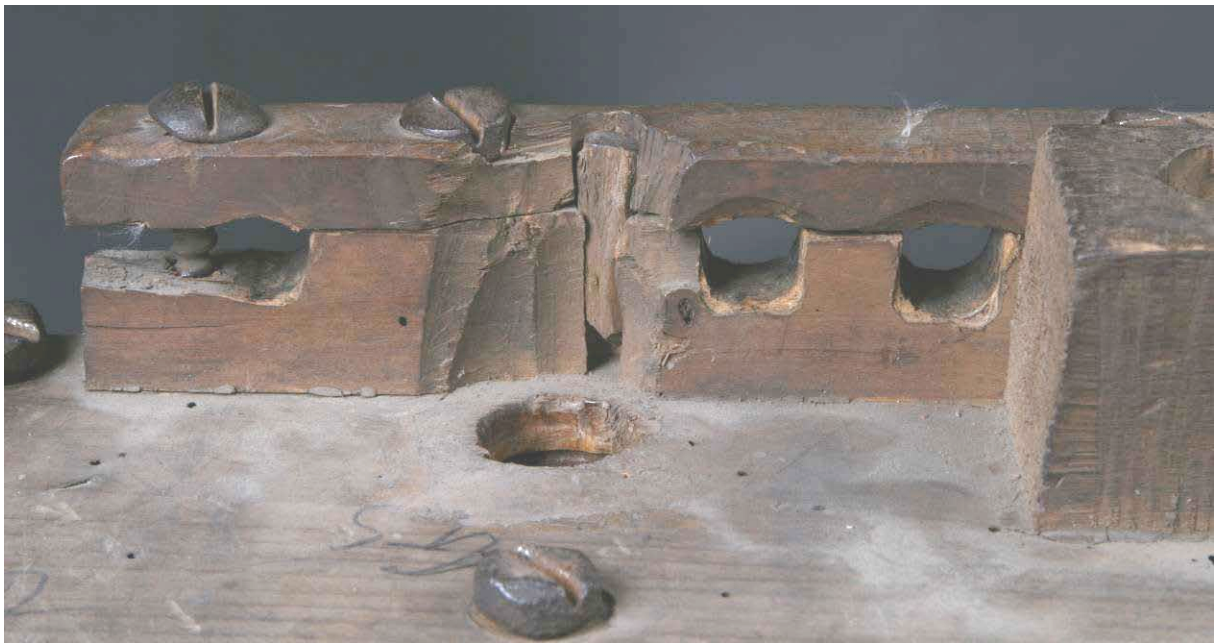
Abbildung 110 Bearbeitetes Registerwellen-Lager auf Stock 3B
