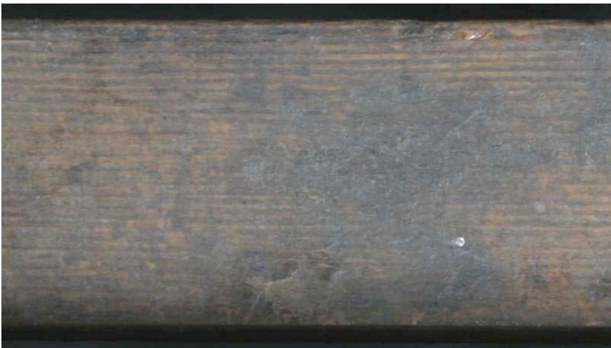
Abbildung 172 Spuren des Zahnhebels auf den Hebeln der Obertasten
