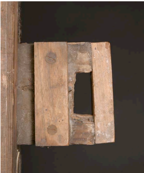
Abbildung 197 Draufsicht Befestigung des Aufzugsriemens an der Balgplatte bei Balg 1
