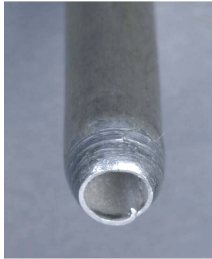
Abbildung 70 Maschinell eingekulptes Fußloch bei 2. Reihe Mixtur, g°
