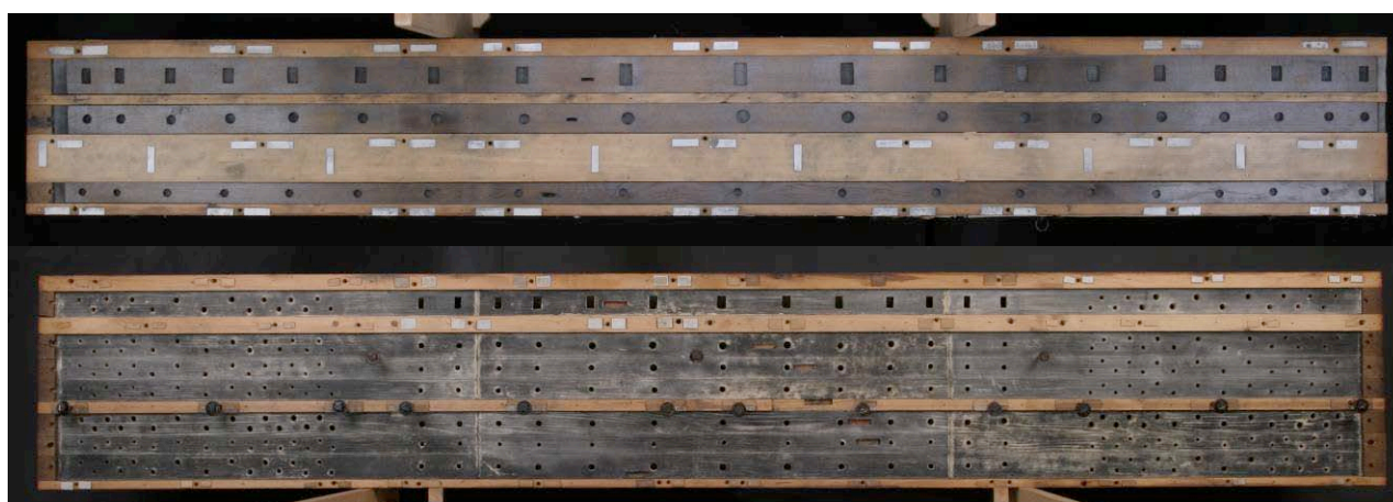
Abbildung 81 Gesamtansicht Stockseite, unten Manual (ohne Schleifen) und oben Pedal (mit Schleifen)
