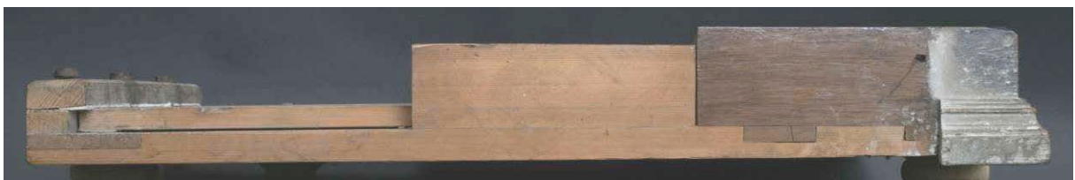
Abbildung 150 Klaviatur Seitenansicht, hinter den Klaviaturseitenbacken die Aufdoppelung für die Befestigung am Lagerbalken der Registerhebel.
