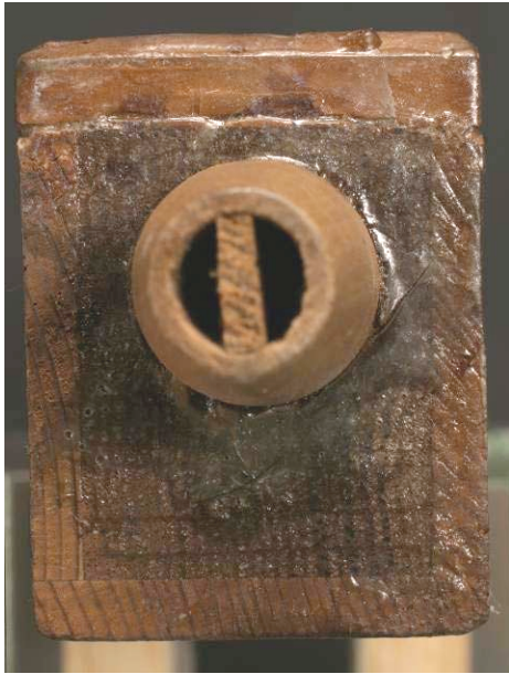
Abbildung 47 Mit Hölzchen verengtes Fußloch, h^\circ
