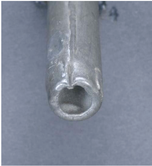
Abbildung 69 Rechtwinklig eingekulptes Fußloch bei 1. Reihe Mixtur, D
