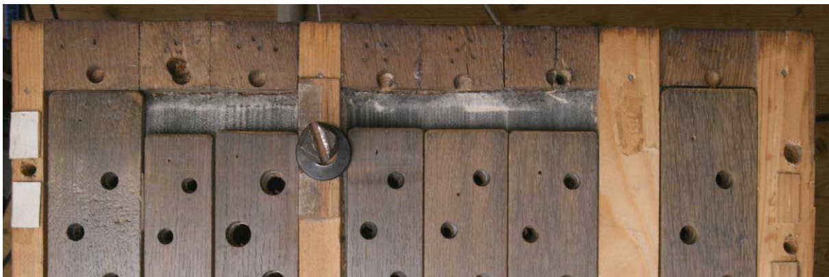
Abbildung 95 Schleifen von 1952 und Reste der alten Schleifen zwischen den Schleifendämmen (Manuallade)
