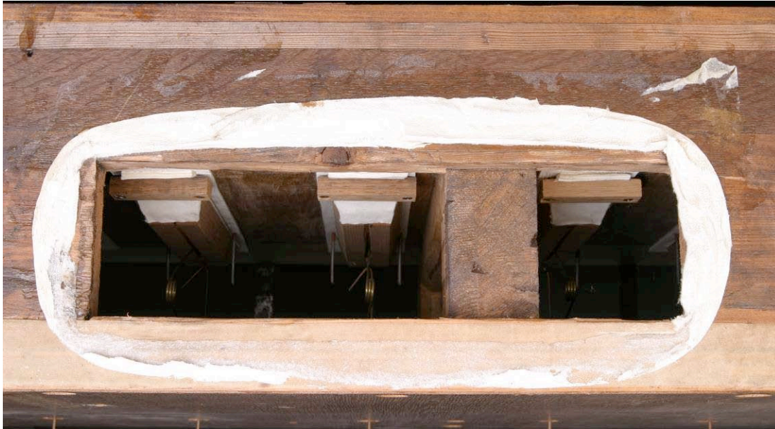
Abbildung 94 Befestigung der Ventilschwänze, Manuallade
