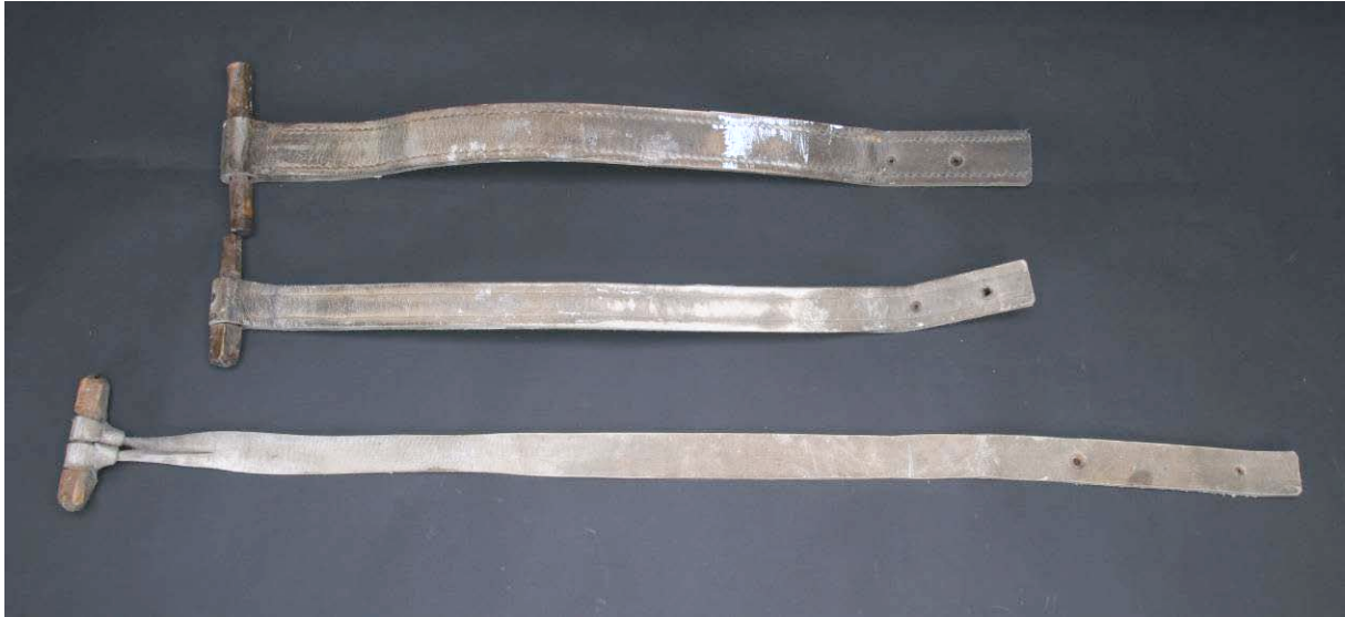
Abbildung 198 Aufzugsriemen mit Schlaufe für den Splint
