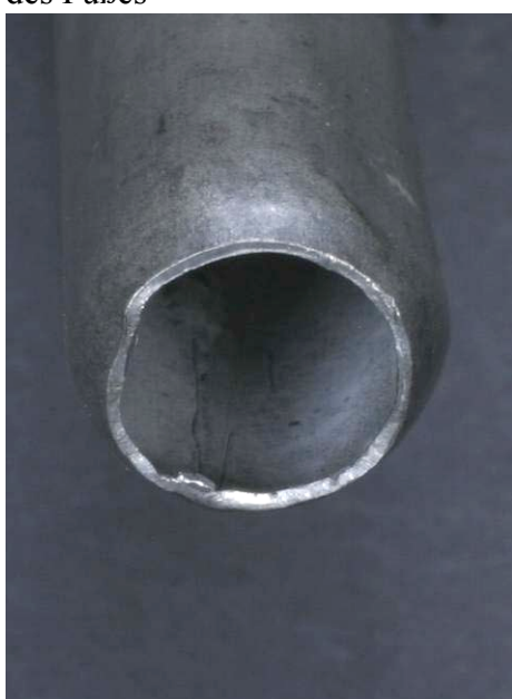
Abbildung 64 Beschnittenes Fußloch bei cs^2
