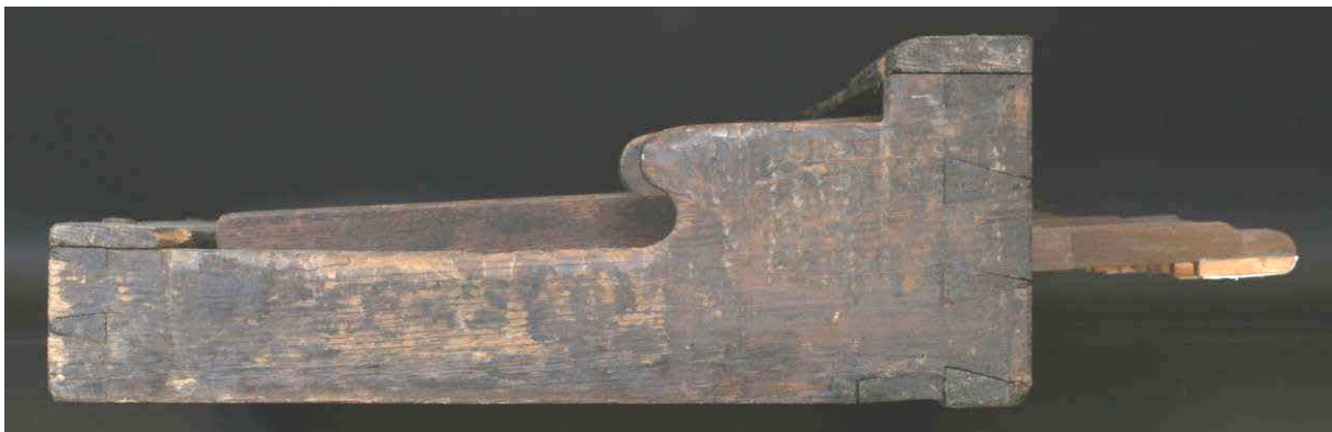
Abbildung 165 Pedal Seitenansicht, an den Hinter-Enden mit nachträglich aufgeleimten Klötzchen
