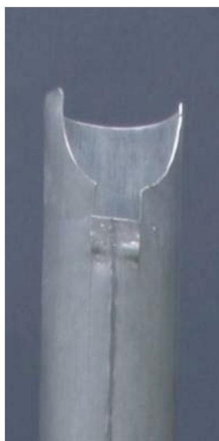
Abbildung 65 Stimmschlitz bei f^\circ
