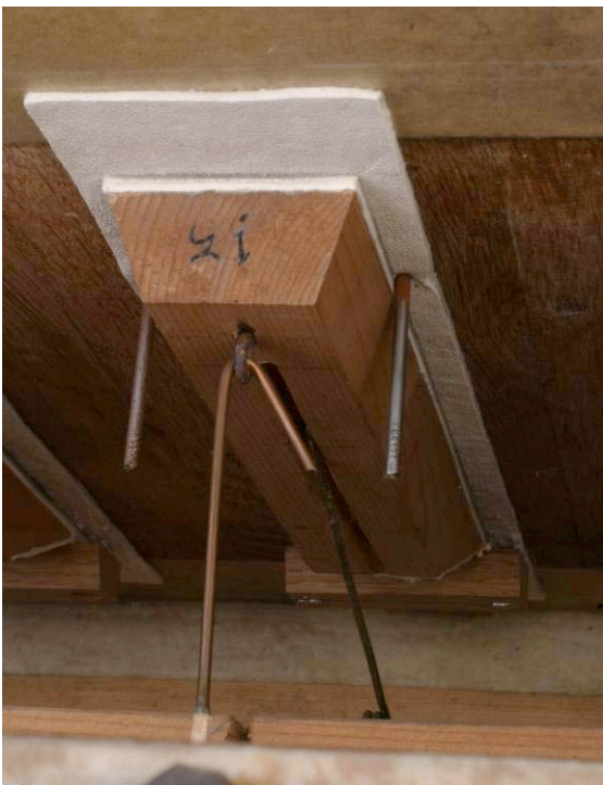
Abbildung 93 Unterseite Manualventile mit Nut zur Befestigung der Feder, Nägel mit abgezwicktem Kopf als Führungsstifte
