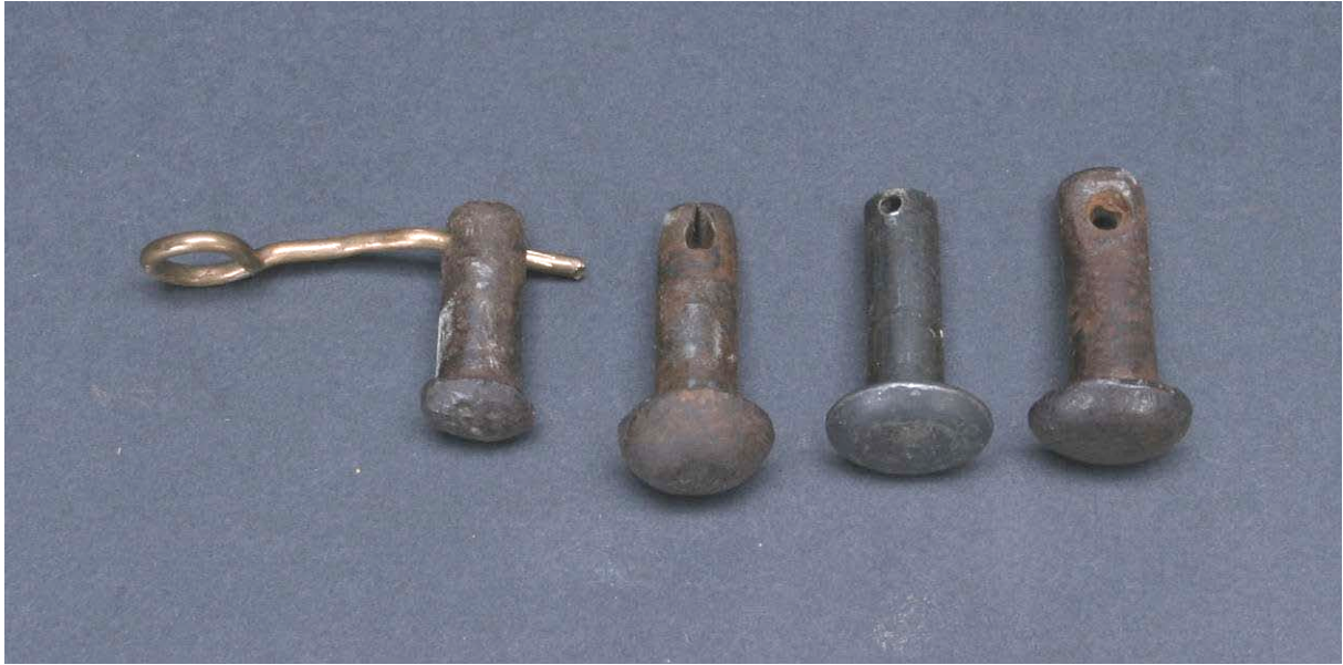
Abbildung 138 Achsen der Register- und Hubstangen, die 2. von rechts ist neu.
