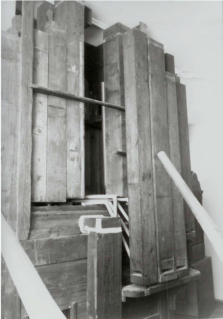
Abbildung 106 Abkonduktierter Stock für Octav- und Subbas an der Rückwand des Gehäuses
