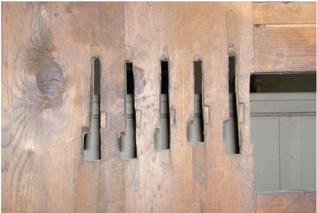
Abbildung 146 Verlängerung der Fenster für die Registerhebel im Gehäuse, jeweils rechts die verschlossenen Aussparungen zum Einrasten der Hebel.
