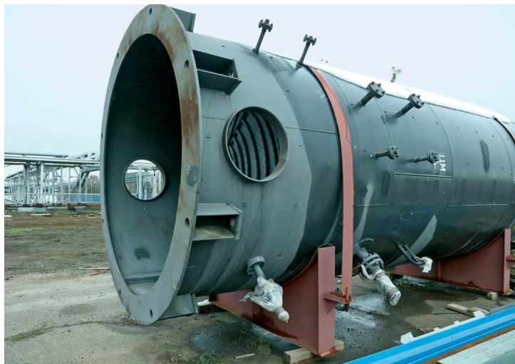
На УКПГ-2 будет установлен новый факельный сепаратор
