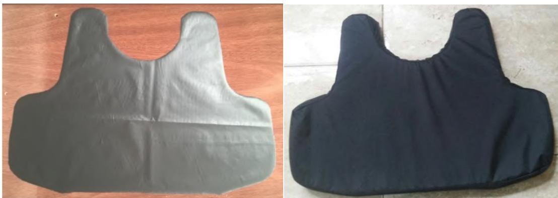
Figura 48- Invólucro impermeável cortado e painel flexível já pronto.
