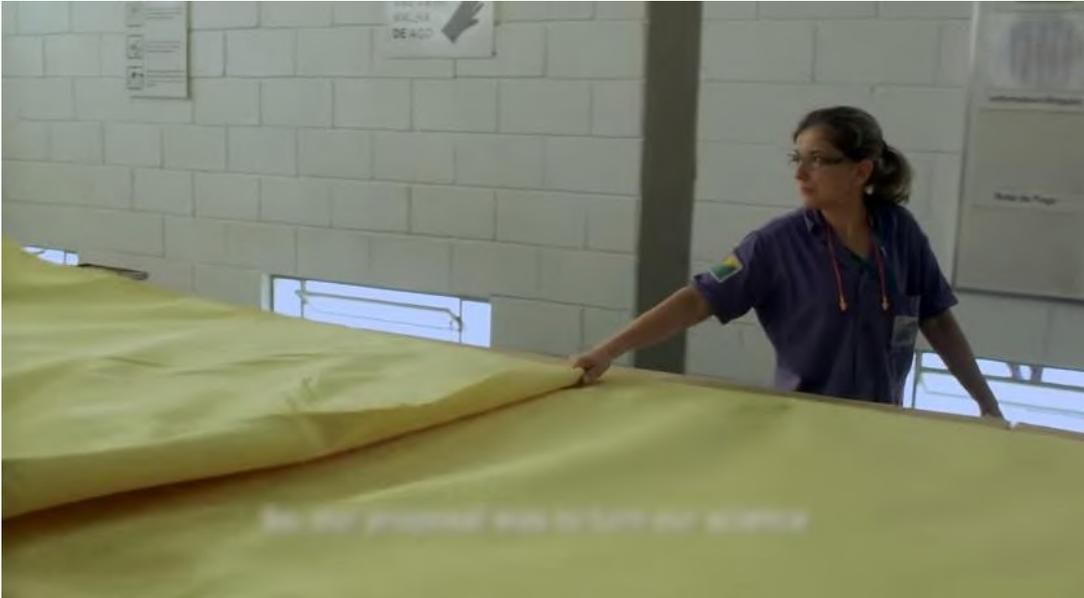
Figura 3 - Tecido balístico sendo preparado para corte.
