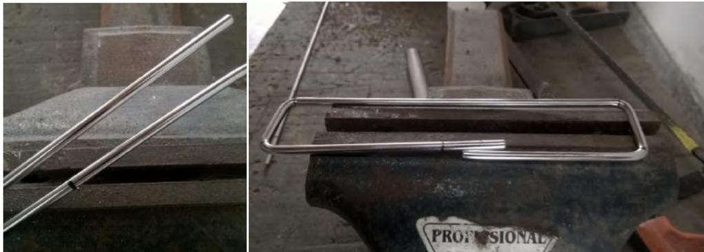
Figura 52- Cabide já cortado e dobrado.
