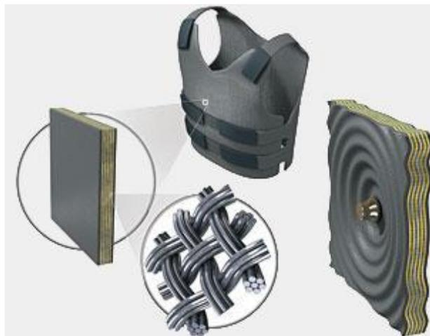
Figura 2- Componentes de um colete balístico, com a ausência da placa balística.
