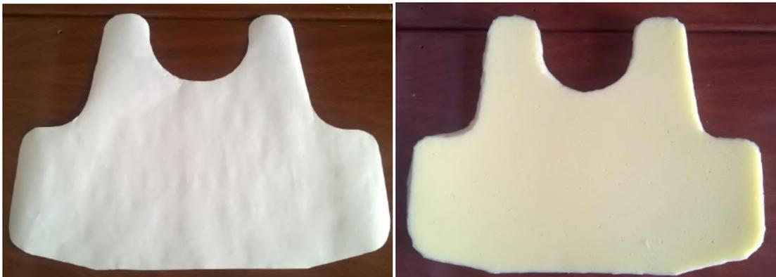
Figura 47- Molde de papel do painel balístico e espuma já cortada nas dimensões corretas.
