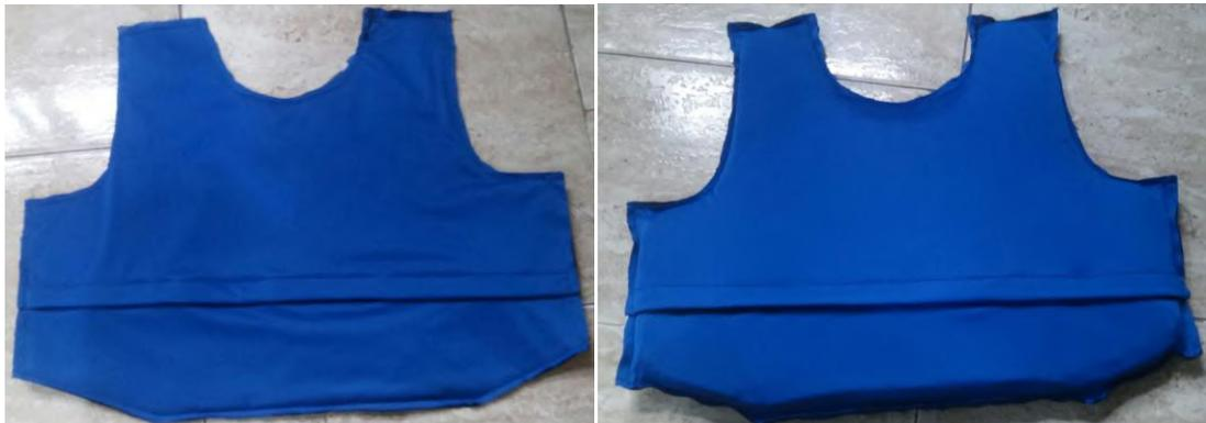
Figura 50- Forro costurado vazio e com o painel balístico.
