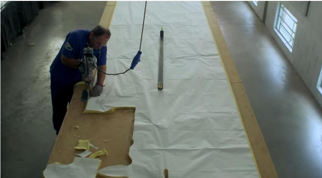
Figura 4- Tecido balístico sendo cortado na Fábrica da Dupont.
