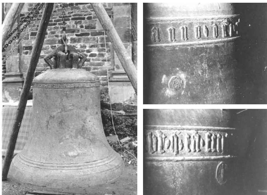
Abbildung 19: a) Glocke des Tilmann von Hachenburg, 1466, Ton f.'-8, 1250 kg, während der Reparatur 1972, b) Detail der Glocke des Tilmann von Hachenburg, 1466, 1250 kg, c) Detail der Glocke von 1466, Ton as'+7, 500 kg. Fotos: Jakob Schaeben, 1972. Mit freundlicher Genehmigung des HAEb Köln.
