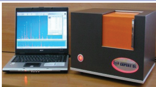
Енергодисперсійний рентгенофлуоресцентний аналізатор «EXPERT 3L»
