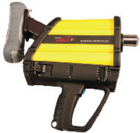
Інфрачервоний фур'є-спектрометр «HazmatID Ranger»
