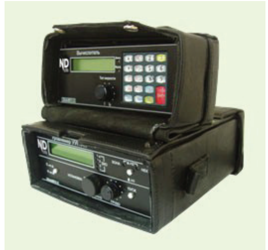
Рівнемір ультразвуковий портативний «УУП1-П1»
