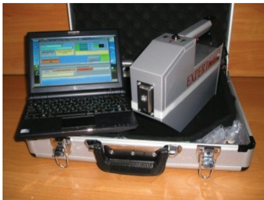
Портативний експрес-аналізатор складу сплавів «EXPERT Mobile»
