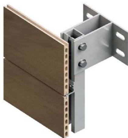
Utilizando este sistema de fachada se obtiene un escudo protector contra la radiación solar debido al espacio intermedio ventilado entre el material y la fachada maciza, por lo que actúa como aislante térmico y reduce, por tanto, la transmisión de calor; y por consiguiente, permite ahorro de costes en calefacción en invierno y climatización en verano.
