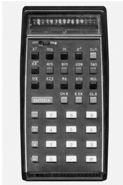
La HP-35 del 1972. Il tasto ENTER (E nell'esempio sopra) serve per separare i dati ed introdurli nella pila.
