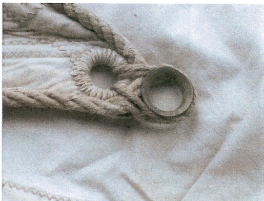
Détail de la voile de Quod Amo. La voile est réalisée dans un coton de première qualité, elle a fait l'objet de réparations.
