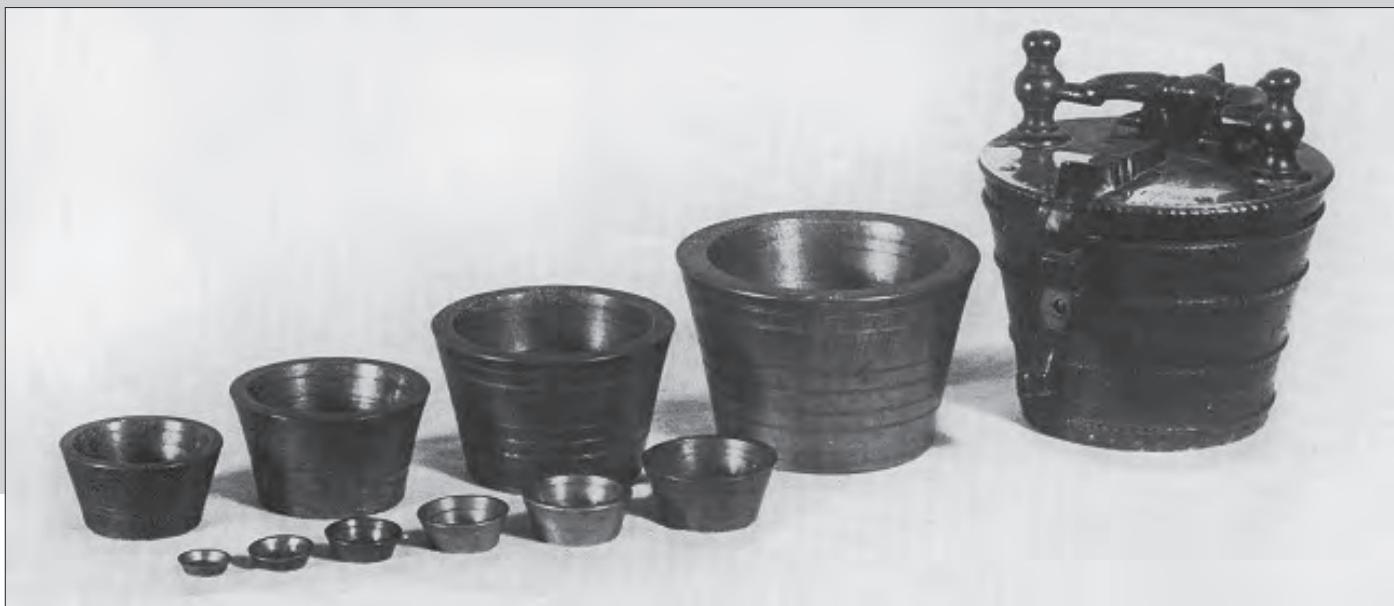
Een sluitgewicht bestaat uit een reeks in elkaar passende kommetjes. Elk onderdeel is een gewicht en ook alle onderdelen bij elkaar zijn dat. Het voordeel van deze gewichtsvorm is het compacte geheel dat gemakkelijk te transporteren is, zonder dat je onderdelen verliest.
