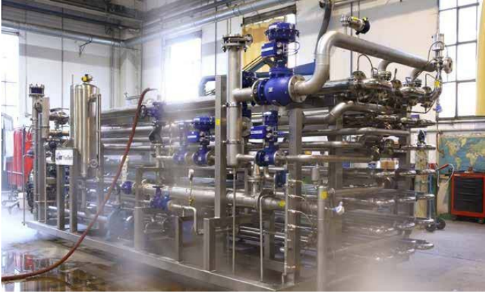
Şəkil 4.5. “Boru boruya” tipli aseptik sterilizator
