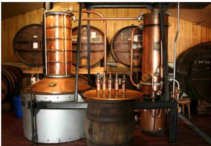
Şəkil 7.2. Kalvados spirtinin alınması üçün aparat
