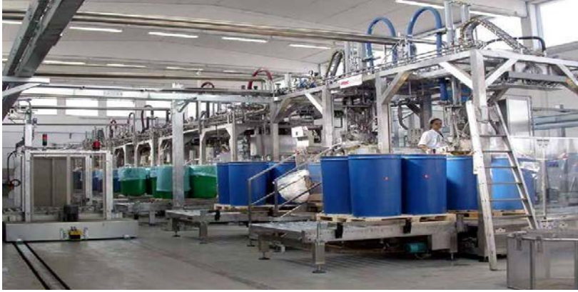
Şəkil 4.6. Şirələrin aseptik işlənməsi
