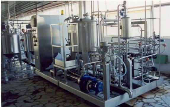
Şəkil 4.8. Qatılaşdırılmış nar və digər şirə yaxud təbii pürelərin sterilizəsi üçün vərəqəli (nazik qatda) sterilizator- sterilflash
