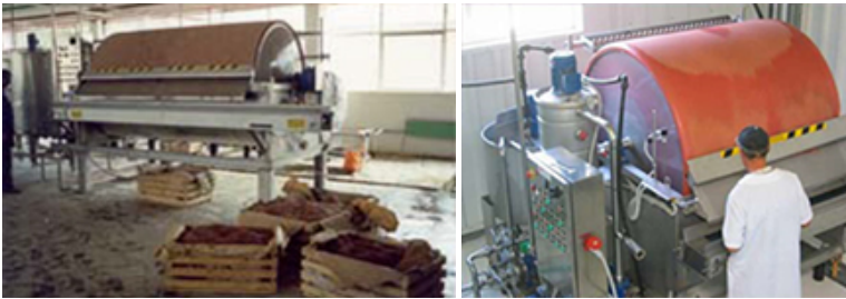
Şəkil 5.2. Kizelqur təbəqəli vaakum fırladıcı filtrdə nar şirəsinin kolloid və özülü hissəciklərdən təmizlənməsi
