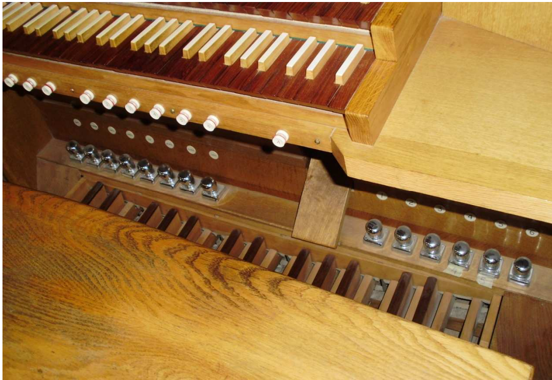
Ilustración 13: Teclado de pedal y combinaciones existentes en la parte inferior.
