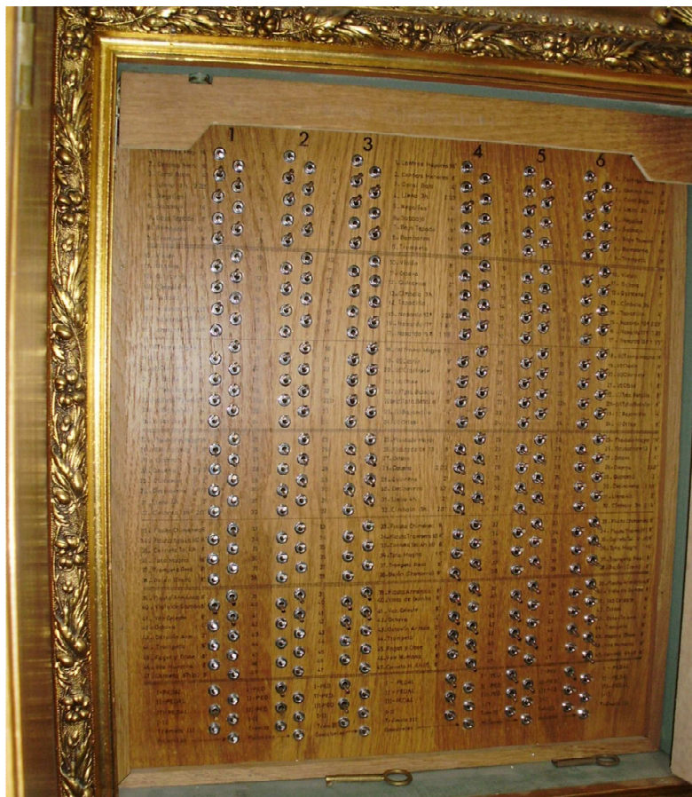
Ilustración 16: Programador de registros del órgano, hasta 6 combinaciones posibles.
