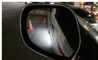
LEDテープ装着後の点灯
