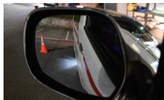
路肩灯のみ点灯
