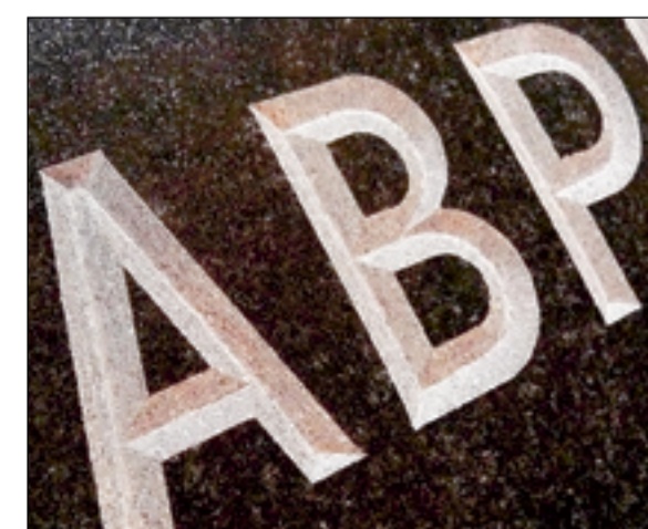
Нанесение надписей сусальным золотом — самый трудоемкий процесс, который приносит самый долговечный результат. Необходима идеальная вырубка по глубине и качеству сколов, потом производится грунтовка, а само сусальное золото укладывается губкой на слой специального лака
