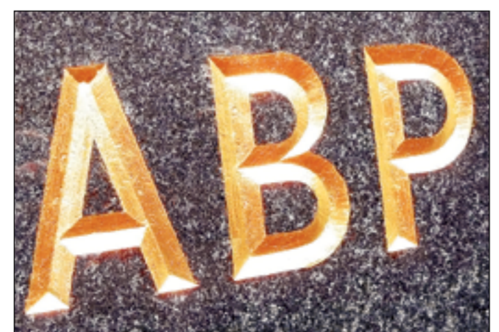
Нанесение надписей сусальным золотом — самый трудоемкий процесс, который приносит самый долговечный результат. Необходима идеальная вырубка по глубине и качеству сколов, потом производится грунтовка, а само сусальное золото укладывается губкой на слой специального лака
