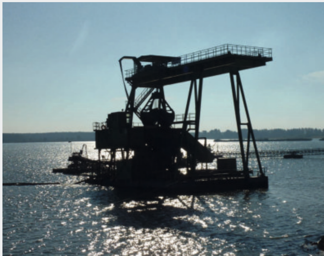
Im Kieswerk Laußig kommt ein schwimmender Greiferbagger zum Einsatz
