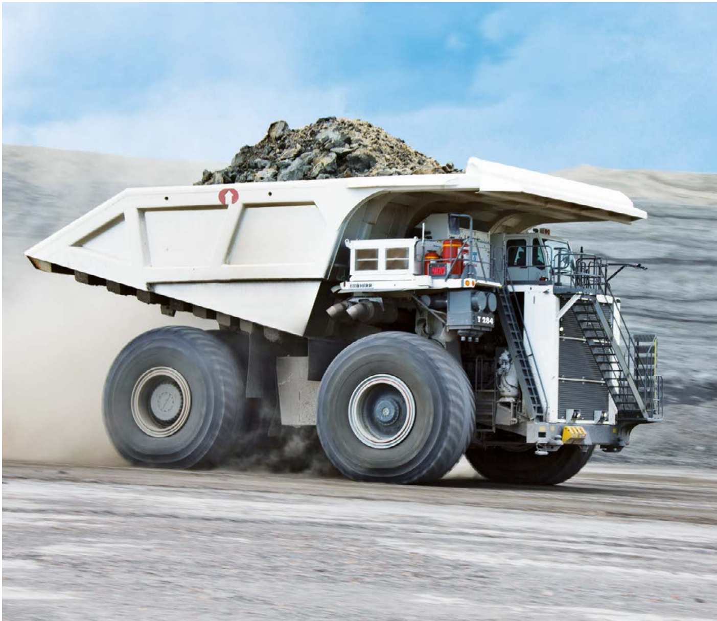
Der Mining-Truck T 284 hat ein Gesamtgewicht bis 600 Tonnen
