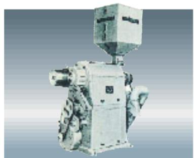
(写真17) 研削式ワンパス精米機(HS型)
