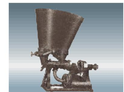
(写真9) 循環式精米機
