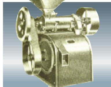
(写真4) エンゲルバーク精米機(後年のモデル)
