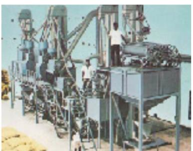
(写真18) コンパス精米機による4t/hプラント
