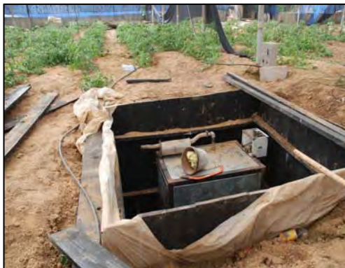
גנראטור וכלי החפירה, שהתגלו בסמוך לפיר של מנהרה. הטמנת הגנראטור באדמה בתוך חממה נועדה להשתיק את הרעש שלו ולהקשות על גילוי (16 באוגוסט 2007, אתר דובר צה"ל)
